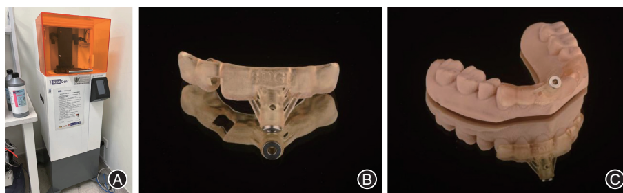
图4 病例1依据数字化设计结果打印3D导板 A:Nextdent 3100 3D打印机;B:3D打印导板成品;C:导板于工作模型试戴。
